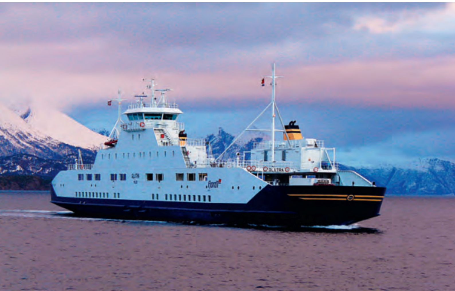
ERFARING: I Noreg har me over ti års erfaring med gassdrevne skip. Her Fjord1 si ferje MF Glutra som vart bygd for LNG-drift så tidleg som i 2000. FOTO: RONNY KVANDE
