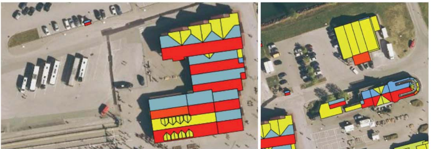
Figur 33 Oversiktsbilder over takarealer med innstråling. Mall of Norway og Flåm kundesenter på bildet til venstre og Coop Marked bildet til høyre. Kilde: Solkart.no
