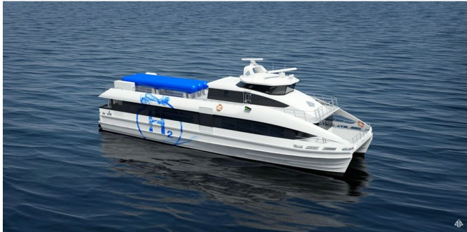
Bredene Aa har designet en 29,9 meter katalanar for 145 passasjerer. Med 500 kg H 2 , 12 x 100 kW brenselceller og to 600 kW elektromotorer, skal den kunne seile 150 nautiske mil i 25 knop. Hydrogentanker på dekk. (Dr. Aa)
