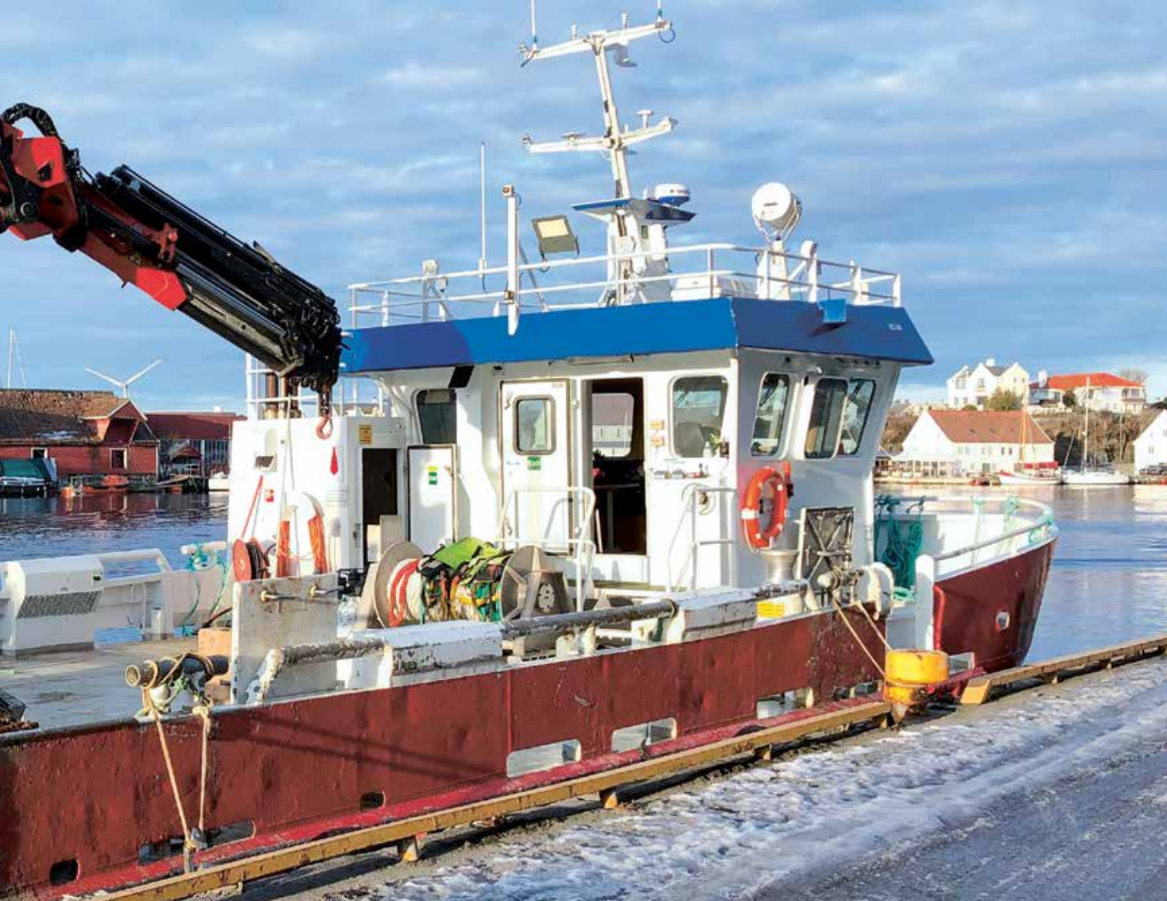
MÅLFRID: Arbeidsbåten Målfrid er en katamaran med største lengde 14,98 meter. Det var på byggetidspunktet (2009) ingen myndighetskrav relatert til bygging av arbeidsbåter med største lengde under 15 meter.
