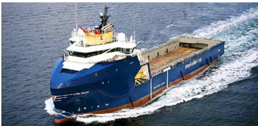
FARTØYET: M/V Stril Polar er i utgangspunktet bygget for operasjoner i kaldt klima, og trengte derfor ikke de helt store endringene for å tilfredsstillende kravene i Polarkoden.
