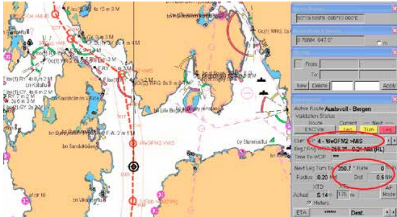
PLANLEGGING: Eksempel på bruk av rutemoniteringsvindu og kursnotasjon. Kursnotasjon samt viktig informasjon for neste kurs er uthevet i rødt. God planlegging sørger for kontinuerlig kontroll av det elektroniske kartsystemet.
