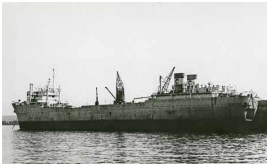
BORESKIP: M/S Thorshøvdi, bygget som hvalkokeri i 1948 for AS Thor Dahl, Sandefjord. Ble bygget om til boreskip ved Akers mek. Verksted i 1966.
