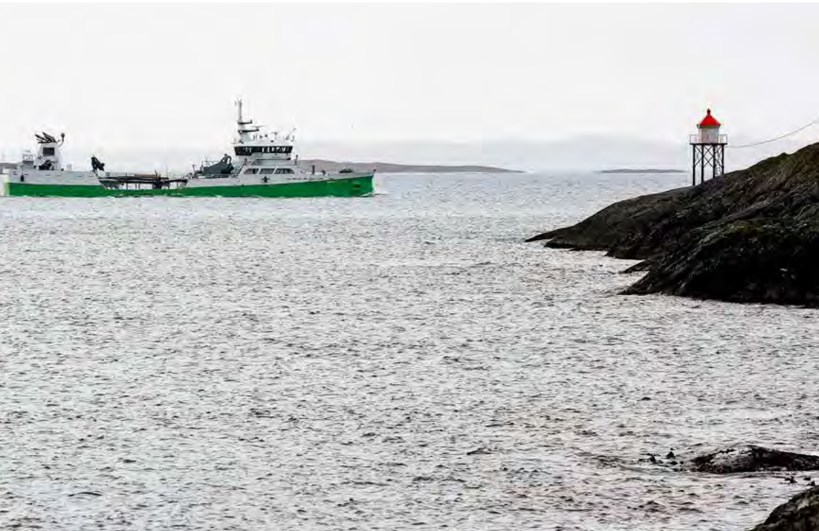
LAVT FRIBORD: Øysund har et typisk brønnbåtdesign, med et lavt fribord ved hoveddekket midtskips, mellom fordekk og akterdekk. I dårlig vær med grov sjø, som på ulykkesdagen, var det mye overvann på hoveddekket. Her på veg over Sletta nord for Haugesund, godt lastet.
