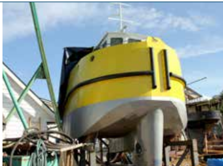
BREI: Den nykonstruerte slepebåten er nesten like brei som den er lang. Den skal bli verdas tryggaste slepebåt når det gjeld stabilitet, meiner verftseigar Andersen. FOTO: KARI STAUTLAND/SJØFARTSDIREKTORATET
