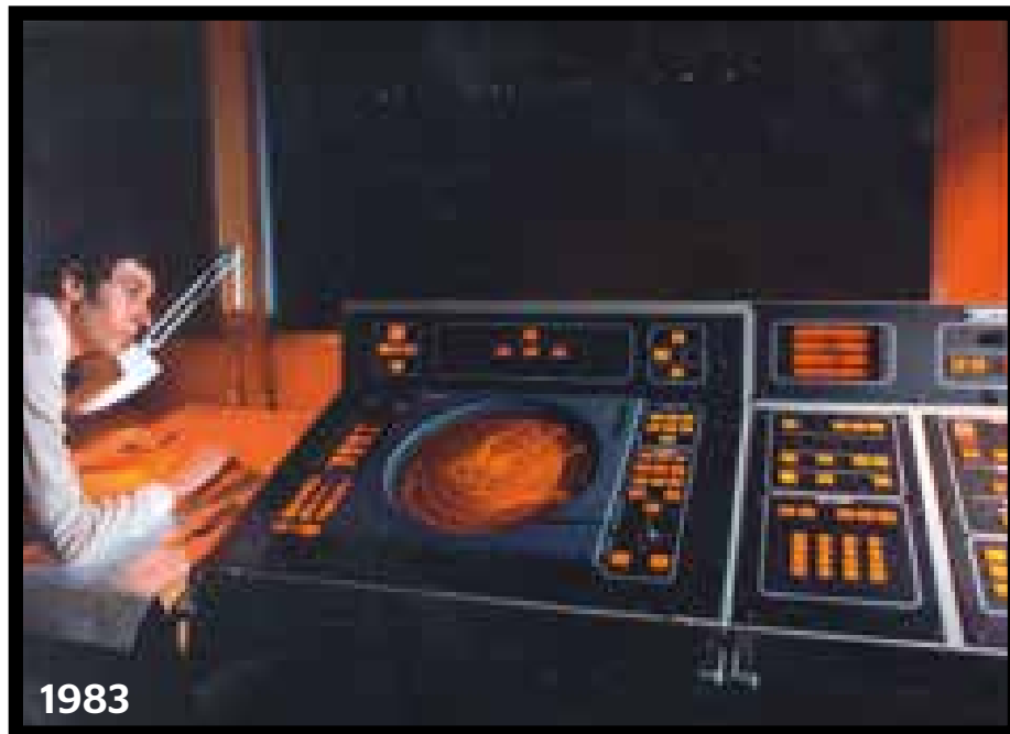
1983: Fra en maritim skole i Leningrad (St. Petersburg), 1983: Norcontrols system NavSim4, et laservisuell system som skjøt ut lys slik at andre fartøyer, farleder og fyrlykter kunne antydes og beregnes. Det ble også projisert en statisk filmet baug som kunne skimtes fra skipsbroen. Systemet, som var utviklet i samarbeid mellom Norcontrol og Christian Michelsens institutt i Bergen, ble brukt for trening på natt/skumringsseiling.
