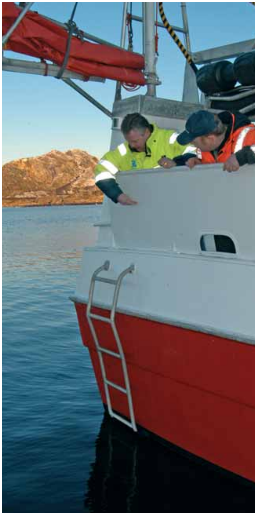
FOR LANGT OPP – Det er bra at du har fastmontert leider, men det er likevel litt langt å rekke opp. Du bør nok montere et ekstra håndtak her, sier inspektør Thore Kibsgaard til Frank Jobansen på ”Hølabuen”.
